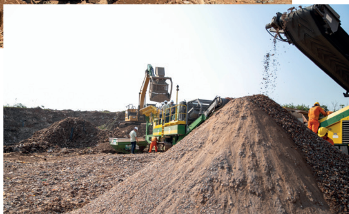
Usina de Reciclagem de Resíduos da Construção Civil de Canoas processa 17 mil m 3 mensais de materiais
